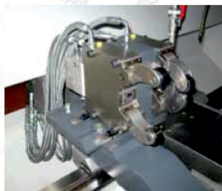
Самоцентрирующий гидравлический подвижный двойной люнет
