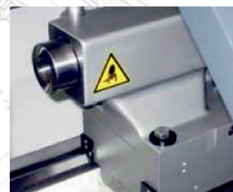
Задняя бабка с гидравлическим управлением выдвигания пиноли
