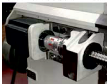
Прямой привод ШВП по Оси Z
