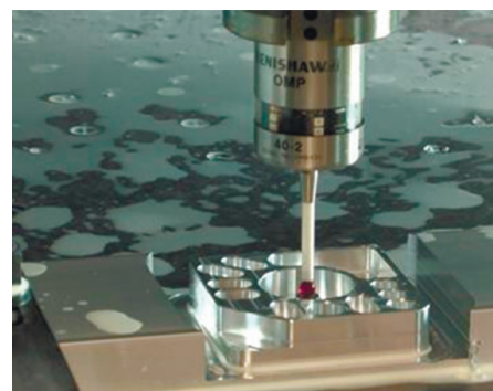
Рис. 6. Процесс измерения детали системой Renishaw
