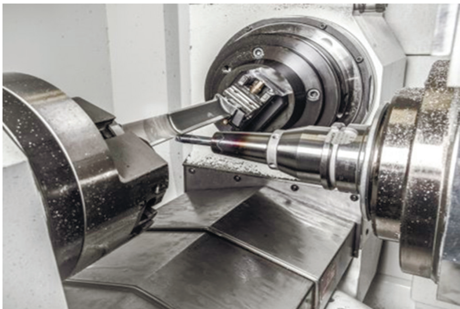
Рис. 5. Обработка турбинной лопатки
